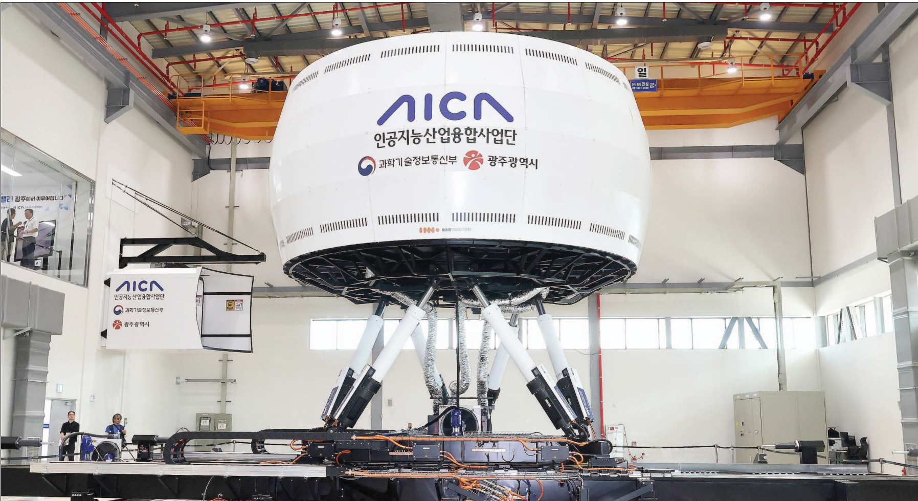
광주 북구 오룡동 광주인공지능전력단지 설치된 드라이빙 시뮬레이터에서 미래차 자율주행 등 인공지능(AI) 기반 차량 실증이 진행되고 있다. 실증지원센터는 실제 주행 상황을 가상으로 구현하고 AI 기반의 자율주행 기술을 개발, 검증할 수 있는 고성능 대형 드라이빙 시뮬레이터 ‘DIL(Driver in the Loop)’이다.
