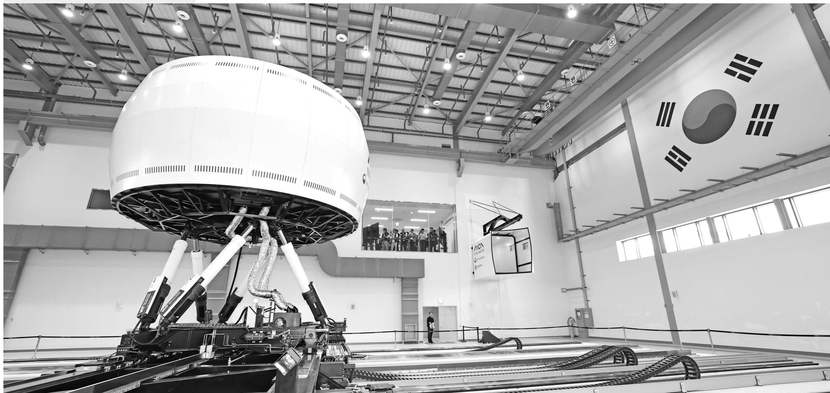
광주 북구 오룡동 광주인공지능집적단지에 설치된 드라이빙 시뮬레이터에서 미래차 자율주행 등 인공지능(AI) 기반 차량 실증이 진행되고 있다. 실증지원센터는 실제 주행 상황을 가상으로 구현하고 AI 기반의 자율주행 기술을 개발, 검증할 수 있는 고성능 대형 드라이빙 시뮬레이터 'DIL(Driver in the Loop)'이다.
