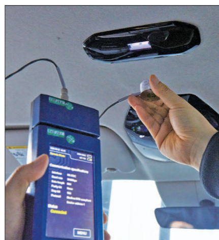
플라즈마 케어 UVC의 파장 에너지 측정 모습.
