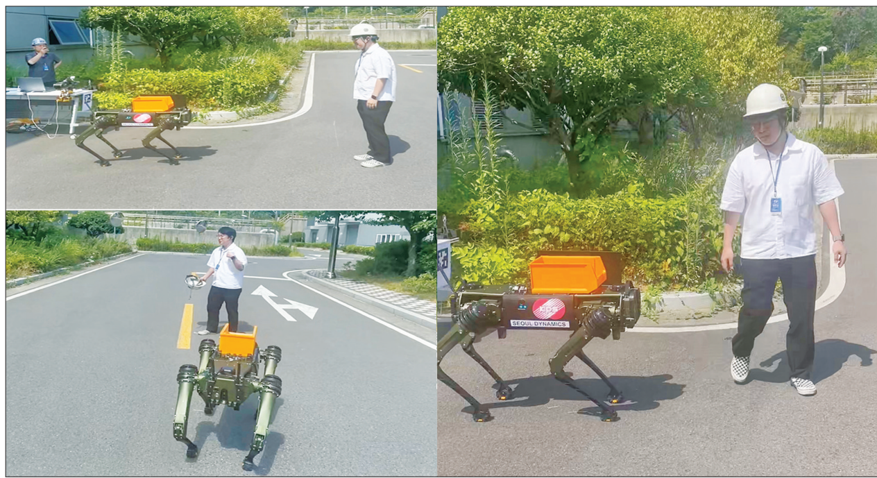
〈좌측 위〉피지컬AI 로봇과 작업자가 작업 전 안전수칙 및 절차 등을 의사소통하는 모습. 〈우측〉피지컬AI 로봇이 작업자를 추종하는 모습. 〈좌측 아래〉작업자 위험상황(헬멧 미착용)에 대해 피지컬AI 로봇이 경고를 올리는 모습.
